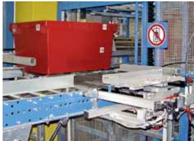
Einschleusstation eines Takthebers für Kunststoffkästen
