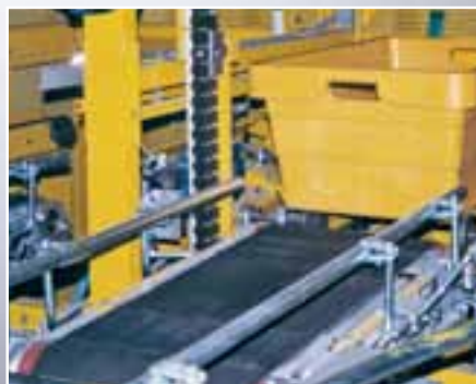
Bei Fördergüter gleicher Abmessungen sind die Fördertische an umlaufenden Gummiblockketten über „Hängestiele“ gelenkig angebracht und werden in Führungsschienen aus Kunststoff über die gesamte Länge parallel geführt. Damit ist ein ruhiger, erschütterungsfreier Lauf garantiert.
