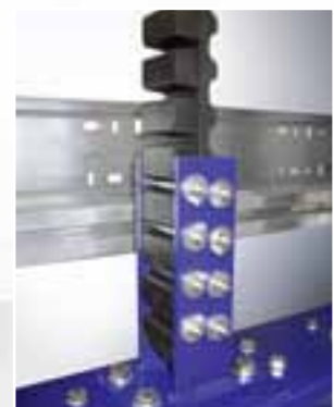
Sichere Befestigung der Gummiblockkette an der Konsole
