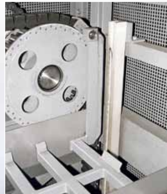
Antriebsrad, Führungsschiene aus Kunststoff und Fördertisch eines Umlaufförderers für Stückgüter unterschiedlicher Abmessungen.
