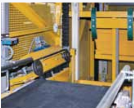
Bei Fördergüter gleicher Abmessungen sind die Fördertische an umlaufenden Gummiblockketten über „Hängestiele“ gelenkig angebracht und werden in Führungsschienen aus Kunststoff über die gesamte Länge parallel geführt. Damit ist ein ruhiger, erschütterungsfreier Lauf garantiert.
