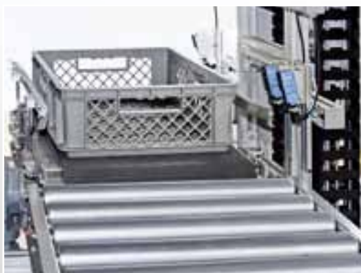
Übergabe vom Gurtförderer auf der Hubkonsole auf nachfolgende Schwerekraftrollenbahn.
